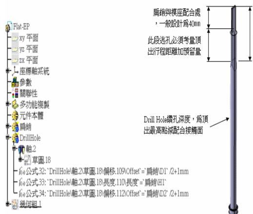
圖 8 扁銷 Drill Hole 設定
